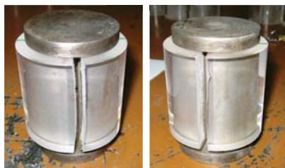
Modo de rotura en muestras de PMMA
