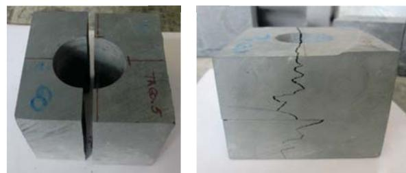
Modo de rotura en muestras de pizarra paralelamente a la foliación (tipo I) y en dirección perpendicular (tipo II)
